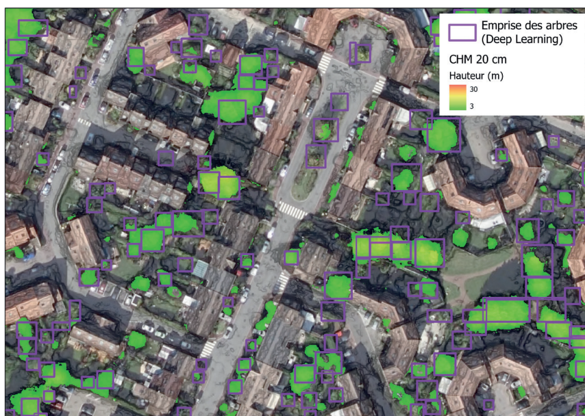
Figure 3 – Emprises des arbres produites par Deep Learning et avec le CHM (Canopy Height Model)
