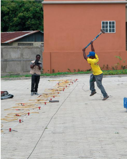
**Profil géophysique pour évaluer la vitesse de propagation des ondes sismiques dans le sol à la cité administrative de Cap-Haïtien : il s'agit de générer une onde de choc dans le sol, et de relever les données enregistrées par les géophones alignés de part et d'autre.** © BRGM
