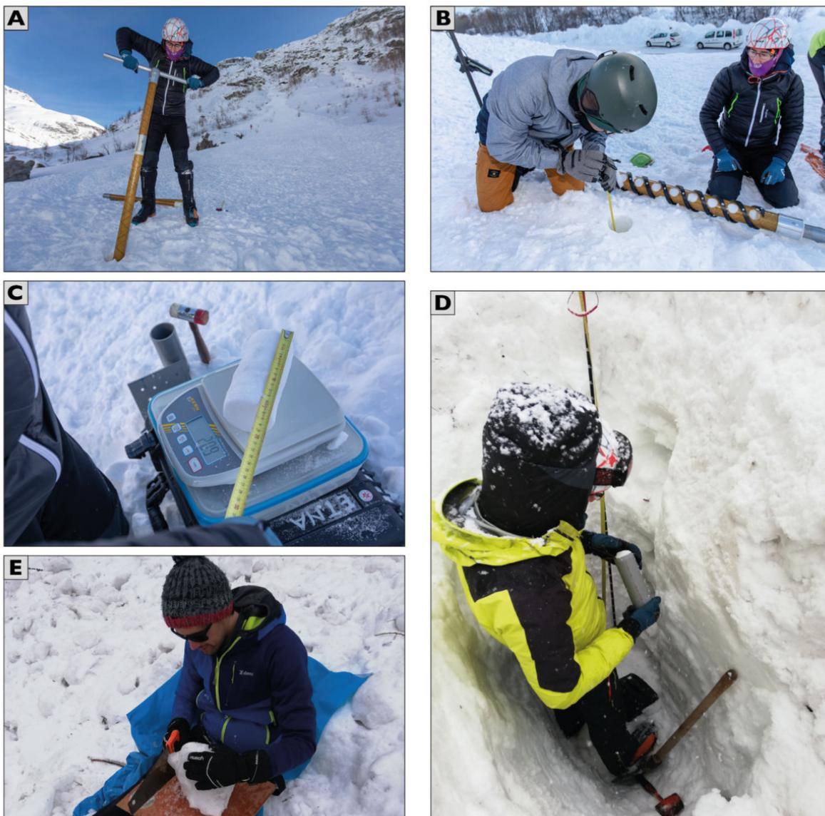
**Figure 28 : Caractérisation du profil vertical du dépôt : (a) carottage du dépôt, (b) mesure de la profondeur d'un puit de carottage, (c) mesure et pesée d'un segment de carotte, (d) prélèvement d'une carotte horizontale au sein d'un puit de neige (e) taille d'un agrégat de surface © Thibaut VERGOZ / LGP / INRAE / CNRS Photothèque / 2019 et INRAE 2020**
