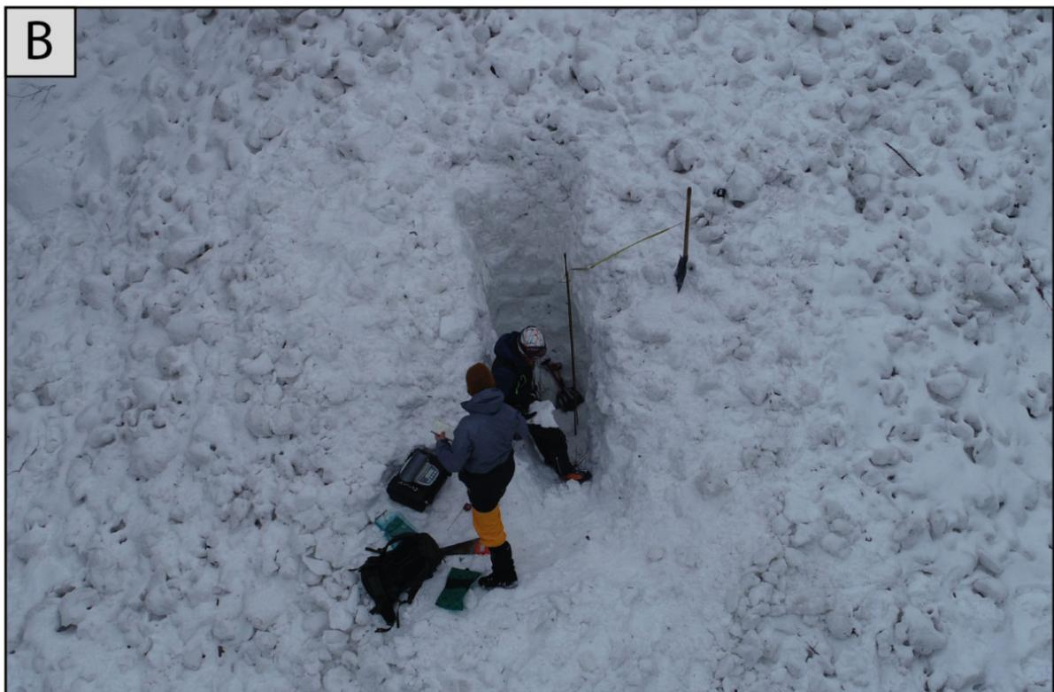
**Figure 9 : Caractérisation nivologique des dépôts d'avalanches, (A) Sondage réalisé à l'aide d'un carottier, (B) Mesures nivologiques depuis un puit de neige (© Thibaut VERGOZ / LGP / INRAE / CNRS Photothèque / 2019)**
