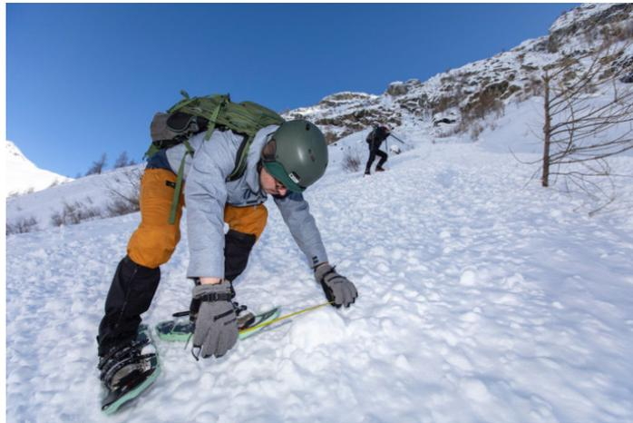
**Figure 26 : Mesure de la longueur de l'axe perpendiculaire à l'axe principal d'un agrégat à la surface d'un dépôt d'avalanche (© Thibaut VERGOZ / LGP / INRAE / CNRS Photothèque / 2019)**
